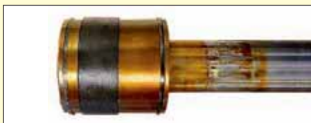
Obr. 1: Ventil zasažený úsadami, které způsobují zasekávání regulace a chybnou funkci
