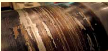
Obr. 4: Velmi silné vrstvy úsad vzniklých degradací jsou stále častějším jevem
