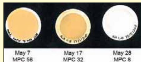
Tabulka 3: Příklad laboratorních membrán. Hodnota \Delta E větší než 40 by měla být důvodem k obavám v jakékoli aplikaci a naznačuje, že mazací systém je již pravděpodobně zasažen úsadami. Výsledek menší než 15 je možné považovat za normální.
