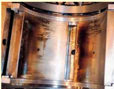
Obr. 2: Velmi silné vrstvy úsad vzniklých degradací oleje jsou stále častějším jevem
