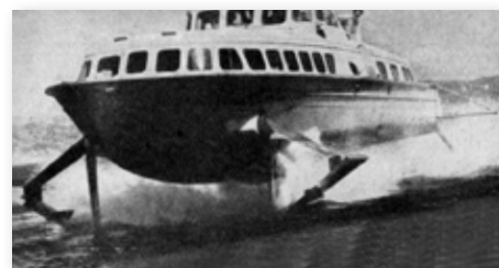
Konstrukce vodoletu PT 20 systému Schertel je 20,6 m dlouhá – převezí 75 cestujících rychlostí 60 km/h.
