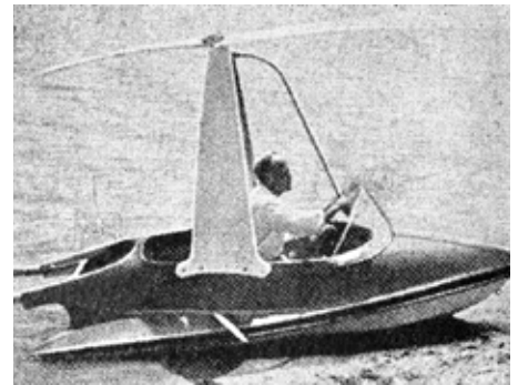
Řidič určuje směr letu změnou polohy vrtule ovládací tyčí
