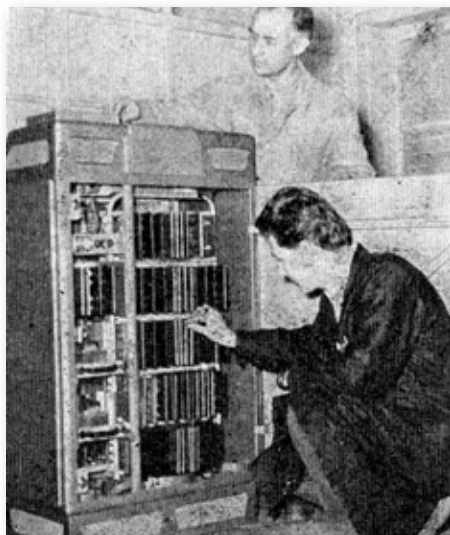
Lineární interpolátor pro řízení obráběcích strojů
