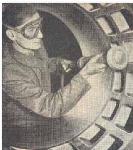
Obr. 3: Opracování plnicích a vyplachovacích kanálů - ze snímku je patrné, jak velký je válec motoru KZ 78/140
