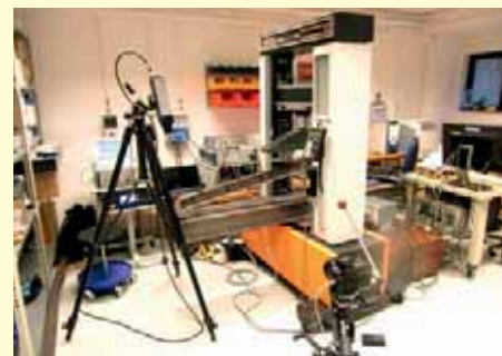
Obr. 4 – Zatěžování modelu ocelového střešního nosníku, vybaveného SHM systémem, na trhacím stroji INSTRON
