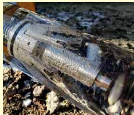
Detail pracující hlavičky IRIS v trubce bez vody a s vodou
