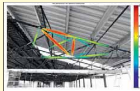
Obr. 6 – Průběhy třech ze sledovaných 20 veličin při postupném zatěžování střešní konstrukce haly (vlevo) a obrázek rozložení nelinearity (defektů) z nelineární ultrazvukové spektroskopie (vpravo)
