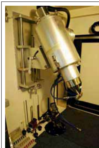
Pomocí trojrozměrné počítačové tomografie lze v obraze oddělit elementy s odlišnou hustotou a zkoumat je samostatně
