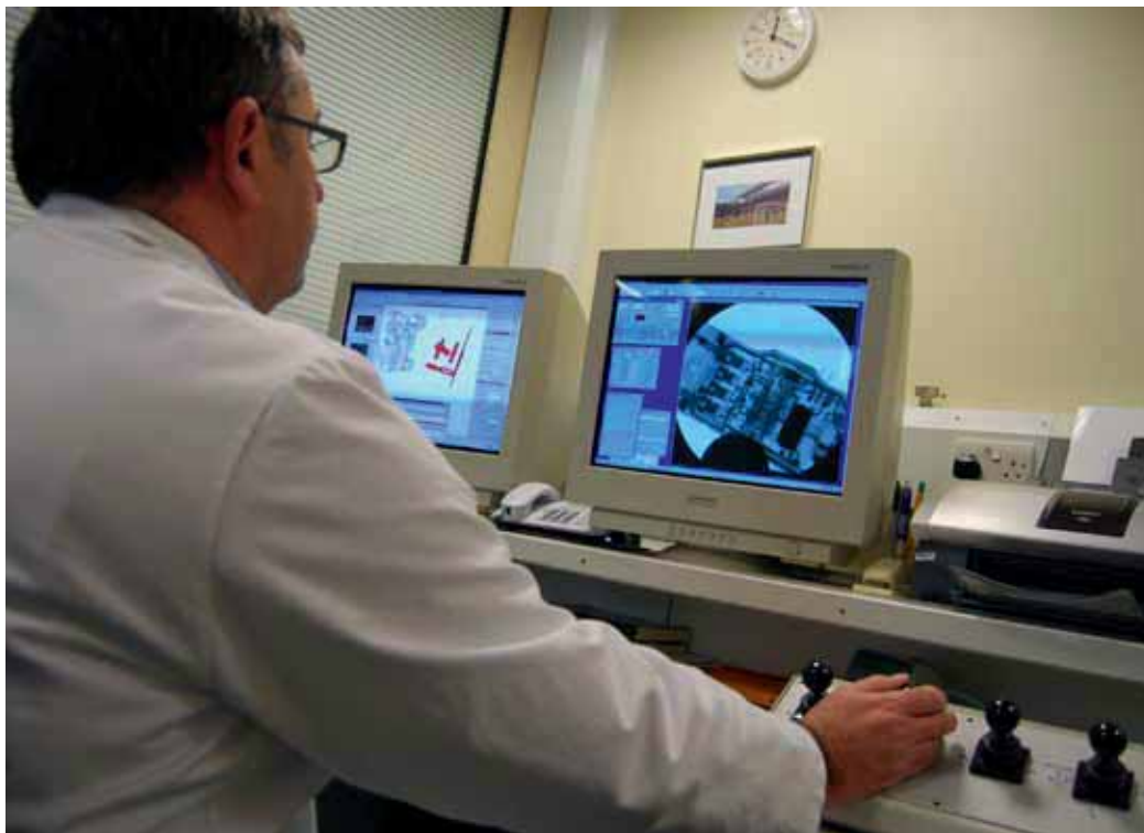
U 2D může operátor přiblížit či oddálit obraz zkoumané součásti, otáčet jím a také regulovat hustotu rentgenových paprsků, ale k nalezení vady je zapotřebí vycvičeného oka
