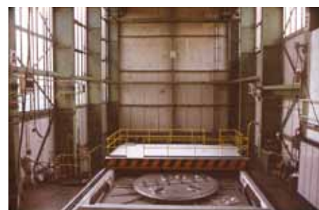
Hala reaktoru LR-0, jak je bývalý těžkovodní reaktor TR-0 označován od roku 1980, kdy proběhla přestavba na lehkovodní reaktor / Zdroj: ÚJV Řež
